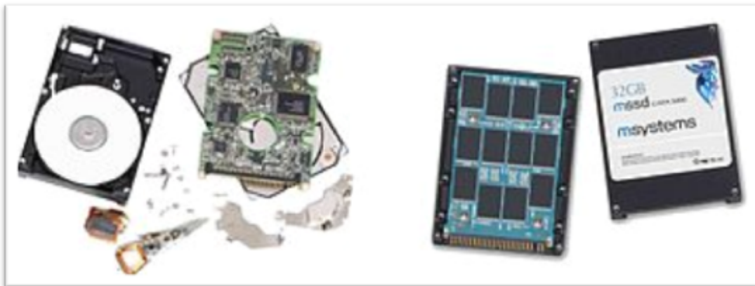
Chasis abierto de un disco duro tradicional. (Izquierda). Aspecto de un dispositivo SSD indicado especialmente para ordenadores portátiles (Derecha).
