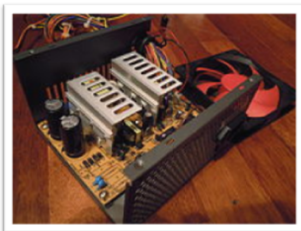
Fuente de alimentación para PC (sin cubierta superior, para mostrar su interior y con el ventilador a un lado).
